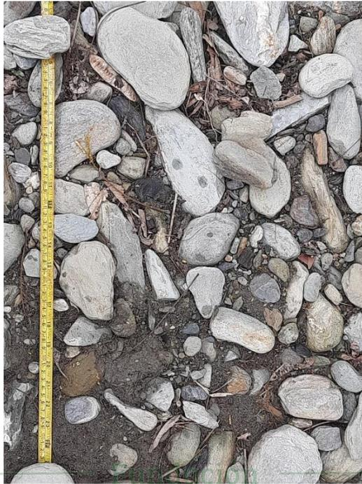
Fotografía 68 granulometría de la fracción fina de la quebrada La Plata.
