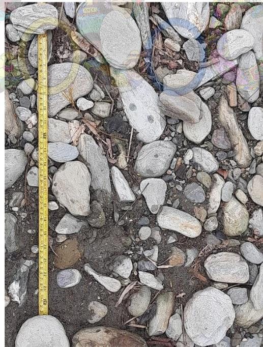
Fotografía 69 granulometría de la fracción fina de la quebrada La Plata.
